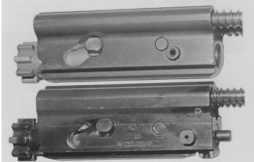
Portaotturatori a confronto, sopra AR-18, sotto EWS
