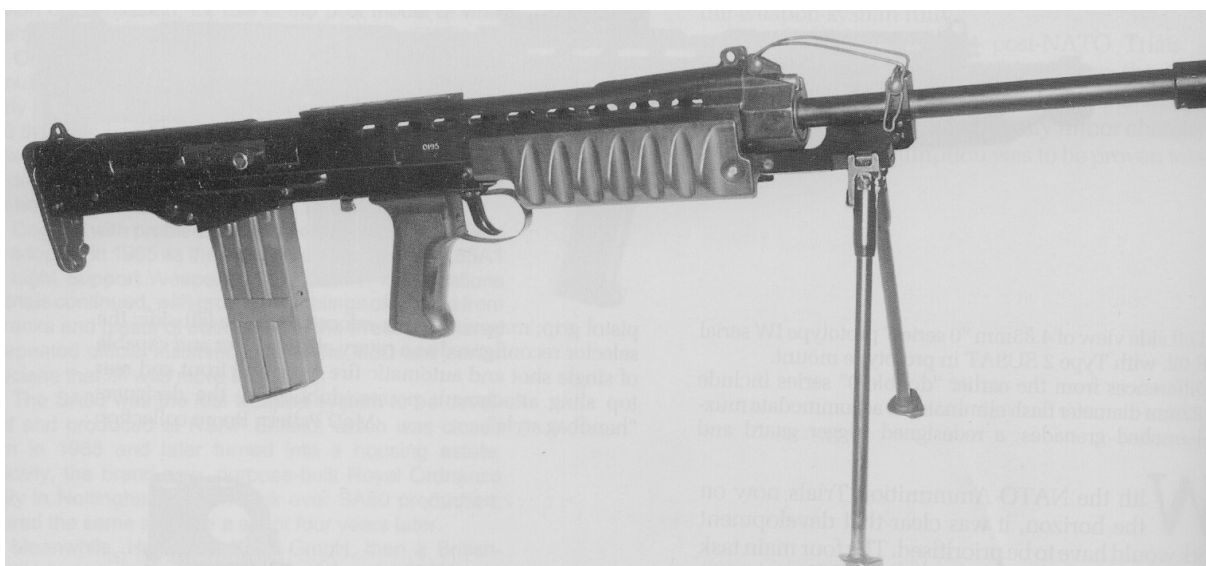
LSW serie "0" con canna sostituibile
