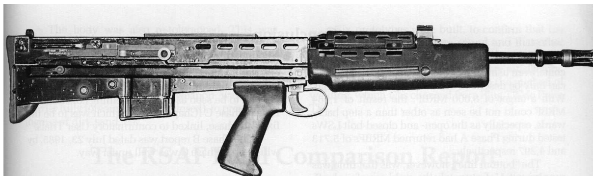
Uno dei 3 XL85E1 della fase B, con pezzi di L85 riutilizzato per i test del 1988/89
